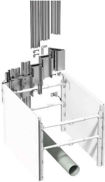
Para asegurar los tapes finales de una zanja contra el colapso. Entibación conforme a la normativa pertinente. Se puede combinar con entibación ligera de aluminio y con entibación de panel con cámara de aluminio. Apto para el uso hasta 3 m de profundidad de zanja. Solución de sistema modular que se adapta fácilmente a diferentes anchos de zanja.
