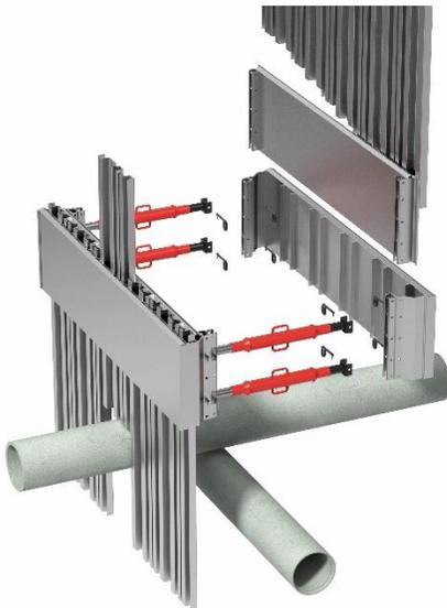
Entibación cuajada flexible y ajustable con paneles de aluminio con cámara y tablestacas, para profundidades hasta 3 m. Posibilidad de dejar aberturas que facilitan el cruce con líneas transversales. Posibilidad de excavación manual con ambos lados protegidos. Gran altura libre para paso de tuberías de gran diámetro.
