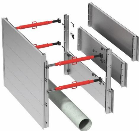
Entibación cuajada, rápida y segura para profundidades de zanja hasta 4 metros. Las diferentes longitudes de los codales permiten anchos de zanja hasta 2,26 m. Se pueden alcanzar mayores anchos de zanja, hasta aproximadamente 6,85 m, mediante tornapuntas.
