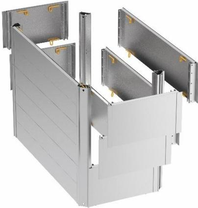
Se pueden realizar pozos de diferentes dimensiones en planta combinando paneles de aluminio de diferentes longitudes. Este sistema permite crear un espacio de trabajo libre, sin codales que obstaculicen los trabajos, con una profundidad hasta 6 m (profundidades de pozo > 3 m solo con paneles de aluminio  $\leq 2$  m).
